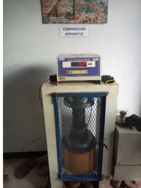
Gambar 2. Sampel Uji Kuat Tekan Beton Sumber : Dokumentasi Penelitian, 2023
