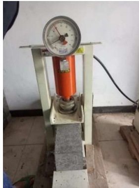
Gambar 4. Pengujian Kuat Lentur Beton
